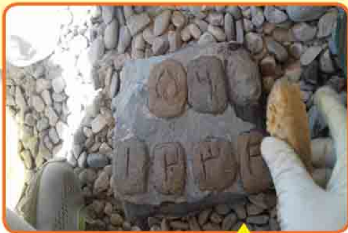
نمونه‌سازی پیش از اجرای ملات جهت انتخاب ترکیب مناسب از لاماژ رنگ، بافت و استمکام مورد نیاز ملات
