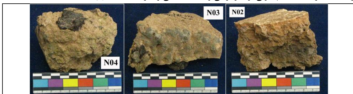
تصویر ۴. تعدادی از آجرهای مطالعاتی بدون لعاب که بقایای درجه حرارت بالا بصورت ساختارهای شیشه‌ای شده و تیره رنگ (جوش کوره) و اندوهدایی از جنس قیر بر روی سطح آن مشخص می‌باشد.
